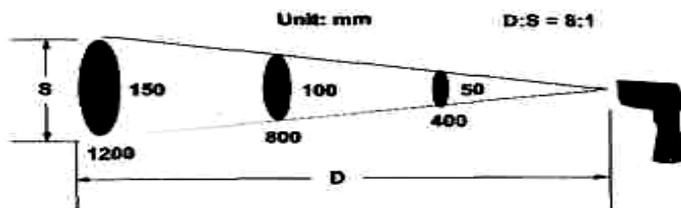
при измерении нужно выбирать расстояние (D) так чтобы размер области измерения (S) был меньше, или равен размеру объекта
