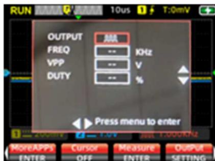
**Примечание:** В текущем режиме, когда форма выходного сигнала представляет собой пульсовую волну, синусоидальную волну и пилообразную волну, максимальное базовое время измерения осциллографа ограничено 100 мкс. Если вы переключитесь на временную базу восстановления, выходной сигнал будет настроен на прямоугольную волну.
