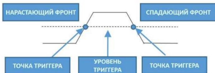
**Нарастающий фронт триггера:** система триггера определяет амплитуду сигнала в процессе нарастания. Система срабатывает, когда амплитуда достигает заданного уровня триггера.
