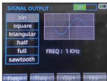
1. С помощью клавиш со стрелками вверх и вниз выберите форму выходного сигнала в виде синусоидальной волны, прямоугольной волны, треугольной волны, полуволны, полноволновой волны или пилообразной волны. Окно отображения экрана синхронно отображает соответствующую форму сигнала.
