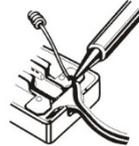
4. Перед тем, как продолжать работать с объектом пайки дождитесь остывания и затвердевания припоя.
