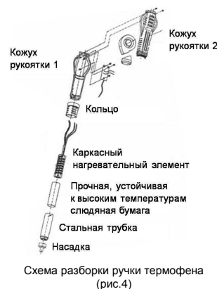
Схема разборки ручки термофена (рис.4)
