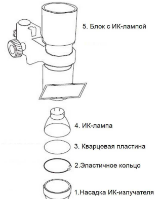
Схема разборки ИК-излучателя (рис.2)
